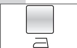
**EASY IRON:** Activando a opção Easy Iron, através do botão **G**, a máquina ajustará os parâmetros de lavagem de maneira a diminuir a formação de rugas na roupa facilitando a passagem a ferro. A velocidade de centrifugação é definida, automaticamente, a 500 rot./min.
